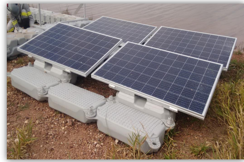
prueba con 2 tipos de tecnología de generación solar flotante
